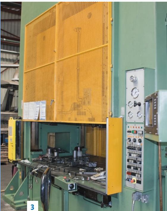
In großen Stahlpressen [3] werden die Edelstahlplatten in die für die Armaturenmontage gewünschte Form gebracht. Der damit erreichbare zweiteilige Aufbau von Stoffschiebern ist offensichtlich ein entscheidender Wettbewerbsvorteil.
